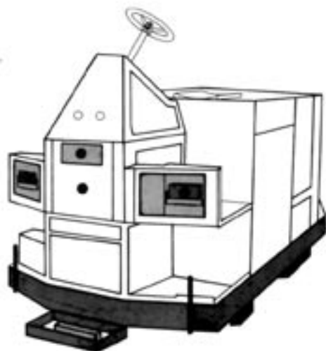
Bild 10.18: Industrieller Fahrroboter mit optischen und Ultraschall-Sensoren. Die Stoßstange und die Verkleidung sind teilweise entfernt. Die Lenkung dient nur dem manuellen Eingriff.
